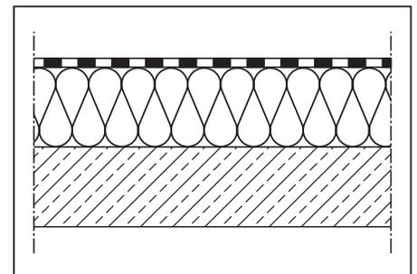
**Tabelle 5.14: U-Werte von massiven Dächern mit Umkehrdämmung. Der massive, tragende Aufbau ist aus Beton mit  $d = 20$  cm und mit  $\lambda = 2,1 W/(m \cdot K)$  angerechnet worden. Unterhalb der Dachisolierung befindet sich keine Dämmung, so dass sich nach [R3] ein Zuschlagswert  $\Delta U$  von  $0,05 W/(m^2 \cdot K)$  ergibt, der in den nachfolgenden Zahlenwerten schon enthalten ist.**
