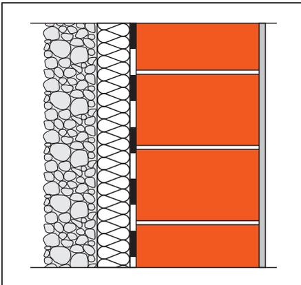
**Tabelle 5.6: U-Werte von erdberührten Wänden beheizter Räume mit 3-4 mm bituminöser Abdichtung und zusätzlicher Perimeterdämmung der Wärmeleitfähigkeit 0,04 W/(m·K).**
