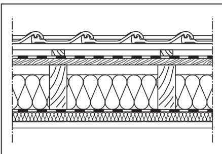
**Tabelle 5.10: U-Werte im Sparren-/Gefachbereich von Dächern mit Zwischensparrendämmung und zusätzlicher Belüftungsebene mit oder ohne Unterdach und 4 cm Untersparrendämmung der WLG 040. Raumseitig ist eine 12,5 mm dicke Gipskartonplatte auf Unterkonstruktion angesetzt worden.**
