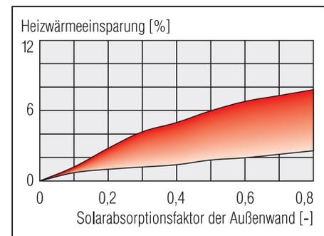
**Bild 2.1: Heizwärmeeinsparung durch Solarabsorption auf Außenoberflächen.**
