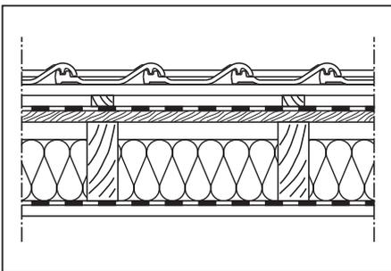
**Tabelle 5.9: U-Werte im Sparren-/Gefachbereich von Dächern mit Zwischensparrendämmung und zusätzlicher Belüftungsebene mit oder ohne Unterdach. Raumseitig ist eine 12,5 mm dicke Gipskartonplatte auf Unterkonstruktion angesetzt worden.**
