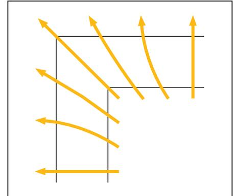
**Bild 6.1:** Wärmestromverlauf durch eine zweidimensionale, monolithische Außenwanddecke.
