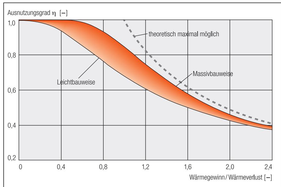
**Bild 3.1: Ausnutzungsgrad der Gewinne in Abhängigkeit vom Wärmegewinn-/Verlustverhältnis.**
