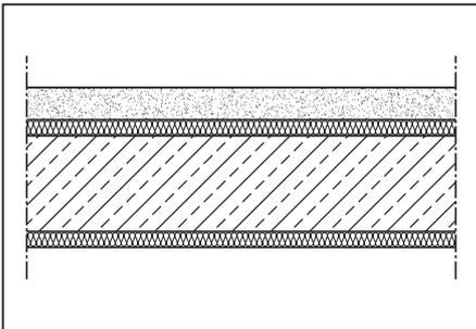
**Tabelle 5.15: U-Werte von Geschossdecken aus Stahlbeton mit 5 cm schwimmendem Zementestrich. Die Lage der Dämmschicht (oberhalb oder unterhalb der Massivdecke) spielt für den U-Wert keine Rolle, ebenso wie die Dicke der Stahlbetondecke.**
