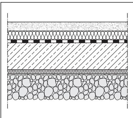
**Tabelle 5.16: U-Werte von Bodenplatten auf Erdreich aus Stahlbeton mit 5 cm schwimmendem Zementestrich. Die Lage der Dämmschicht (oberhalb oder unterhalb der Massivdecke) spielt für den U-Wert keine Rolle, ebenso wie die Dicke der Stahlbetondecke.**
