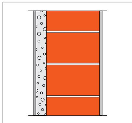
**Hinweis:** Die Wärmeleitfähigkeiten der hochwärmedämmenden Hochlochziegel sind per bauaufsichtlicher Zulassung geregelt. Die Bemessungswerte der Wärmeleitfähigkeit werden immer in Verbindung mit dem zu verwendenden Mauermörtel genannt und gelten für das daraus zusammengesetzte Mauerwerk. Informationen hierzu halten die Produktgruppen und Ziegelwerke bereit.
