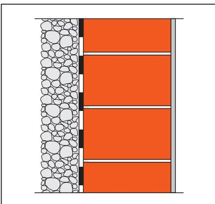
Ziegelmauerwerk im Erdreich ist bei sachgerechter Ausführung mit und ohne zusätzliche Dämmung möglich. Vor allem bei der Nutzung hochwertiger Auf-
