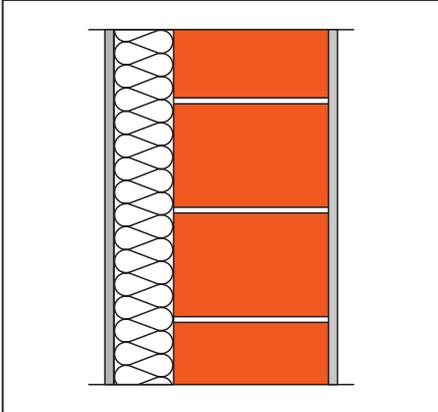
Zusatzgedämmtes Ziegelmauerwerk mit bauaufsichtlich zugelassenen Wärmedämmverbundsystemen (WDVS) kann vor allem im Geschosswohnungsbau bei schlanken Außenwandkonstruktionen eingesetzt werden. Dabei ist vor allem auf eine schwerere Hintermauerung zu achten, um den Schall- und Lärmschutz im Gebäude sicher zu stellen.
